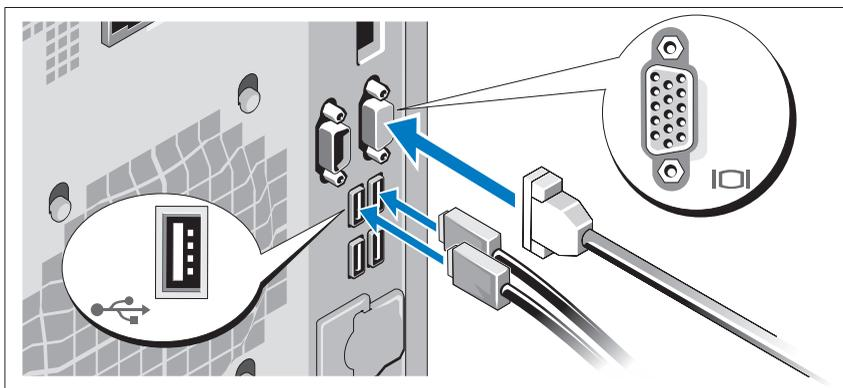
Подключите клавиатуру, мышь и монитор (дополнительно).
