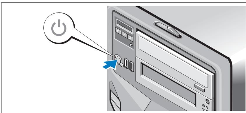
Stiskněte tlačítko napájení na systému. Měl by se rozsvítit indikátor napájení.
