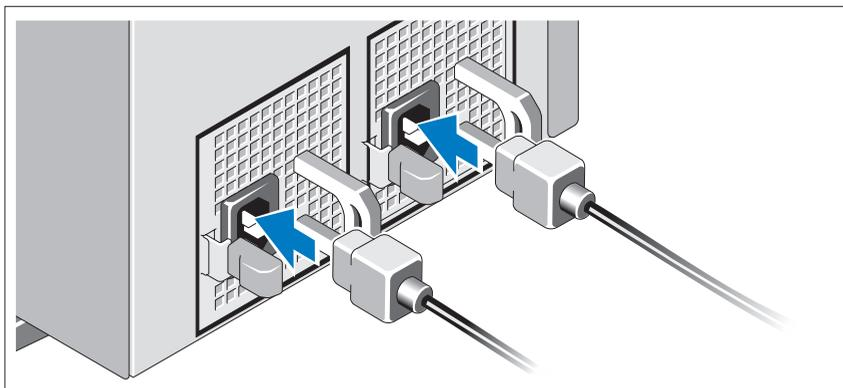
Podłącz odpowiedni kabel (lub kable) zasilania do zestawu komputerowego oraz odpowiedni kabel (lub kable) zasilania do monitora, o ile jest używany.
