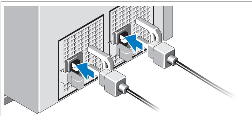
Schließen Sie das/die Netzkabel des Systems an das System an, und schließen Sie anschließend auch das Bildschirmstromkabel an den Bildschirm (falls verwendet) an.
