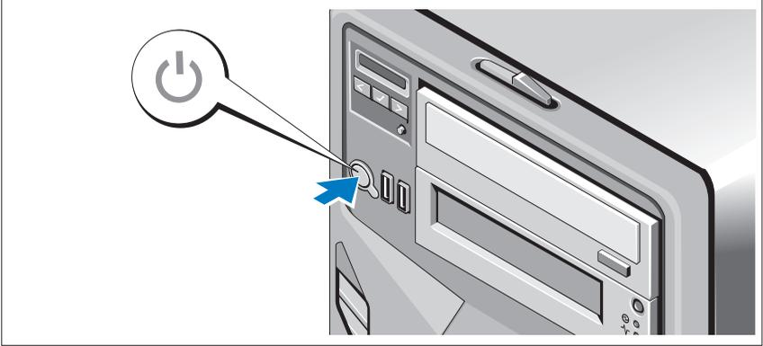
Sistemin üzerindeki güç düğmesine basın. Güç göstergesi yanmalıdır.
