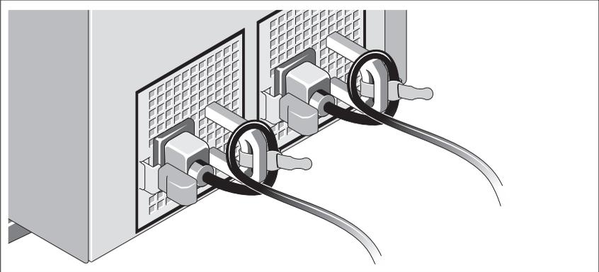
Συνδέστε το στήριγμα συγκράτησης του καλωδίου τροφοδοσίας στον δεξιό σύνδεσμο της λαβής της παροχής τροφοδοσίας. Κάμψτε το καλώδιο τροφοδοσίας του συστήματος σε μορφή βρόχου, όπως φαίνεται στο σχήμα, και συνδέστε το στην αγκράφα του καλωδίου του στηρίγματος.
