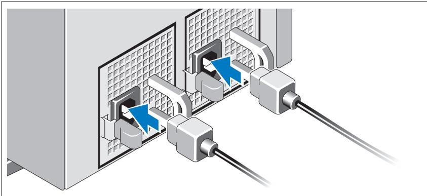
Συνδέστε το καλώδιο (ή τα καλώδια) τροφοδοσίας του συστήματος στο σύστημα και, αν χρησιμοποιείτε οθόνη, συνδέστε το καλώδιο τροφοδοσίας της οθόνης στην οθόνη.
